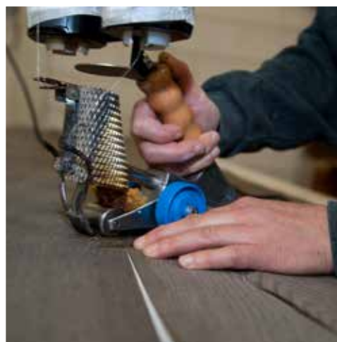
Manual selection and application of slices for bonding. Assemblage à la main de bandes pour le collage.
